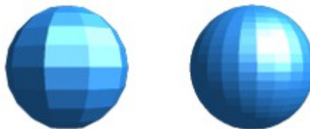
Abbildung 20: Kugel aus 10 Segmenten (links) und 25 (rechts)
