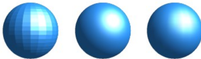
Abbildung 25: Flach-, Phong- und Gouraud-Shading
